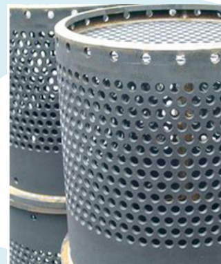
Perforerede kurve til slynggalvanisering af små dele.
