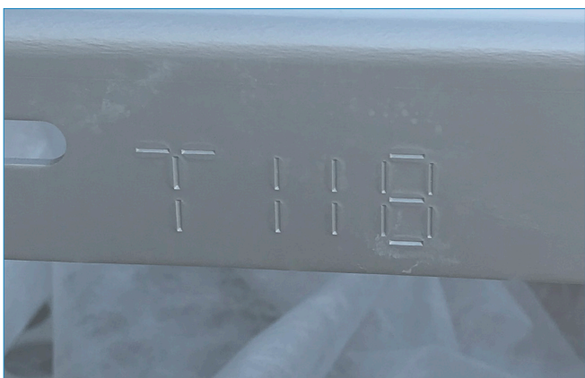
Prægning af strækmetalrammer som mærkning
